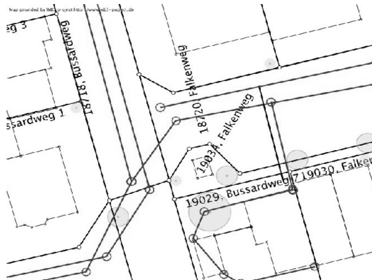
Abb2: Kartenausschnitt aus WB3 mit dem Verlauf unterirdischer Entwässerungskanäle, der Position von Straßenleuchten und Einzelpflanzen. Gezeigt wird nahezu derselbe Ausschnitt wie in Abb. 3.
